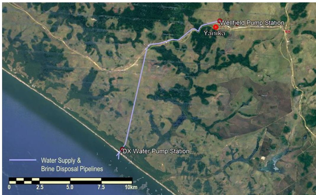
Figure 14 : Itinéraire proposé pour les conduites d'évacuation de la saumure et d'approvisionnement en eau de mer
